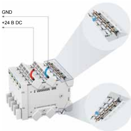
Вигляд 5 модулів збоку: 1 канал живиться через внутрішні ввідні клеми, інші канали живляться через шину.
